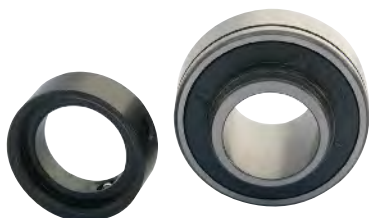
Roulement alésage cylindrique extérieur plat bague intérieure débordante 2 cotés serrage collier excentrique
