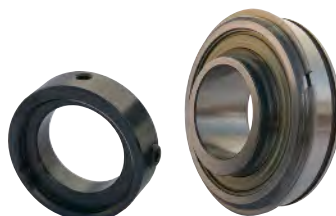
Roulement alésage cylindrique extérieur plat + rainures + clips bague intérieure débordante 1 coté serrage collier excentrique
